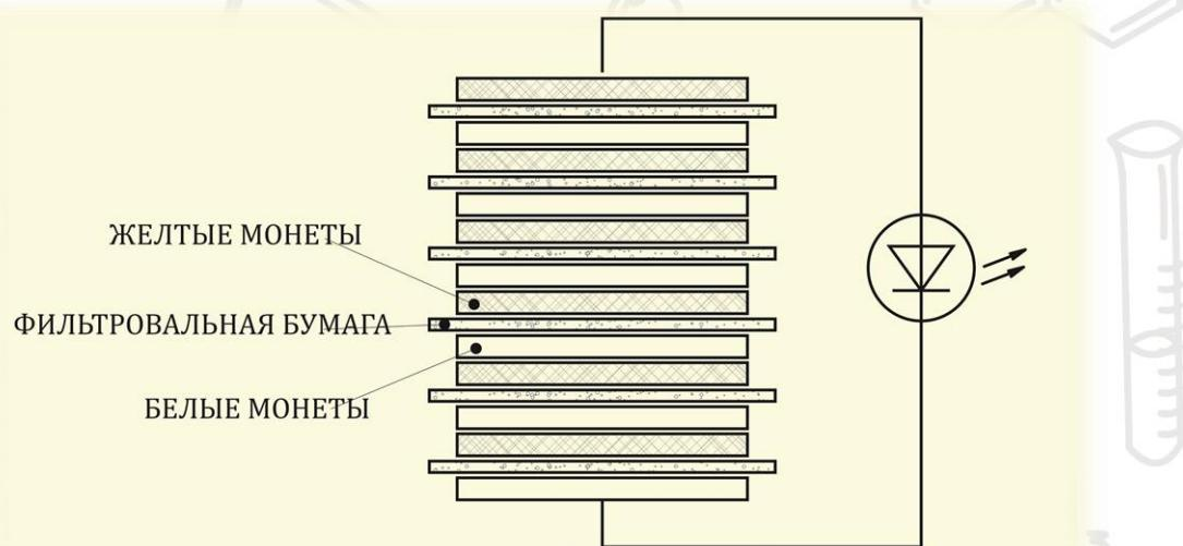
К первой и последней монете подключаются разъемы провода «2 крокодила», которые соединяются с вольтметром, положительная клемма подключается к монете с медным покрытием, отрицательная – к монете с никелевым покрытием. В некоторых случаях бывает неудобно закреплять контакты непосредственно к монетам, в таком случае, можно положить медный или стальной провод на верхнюю монету и под нижнюю
