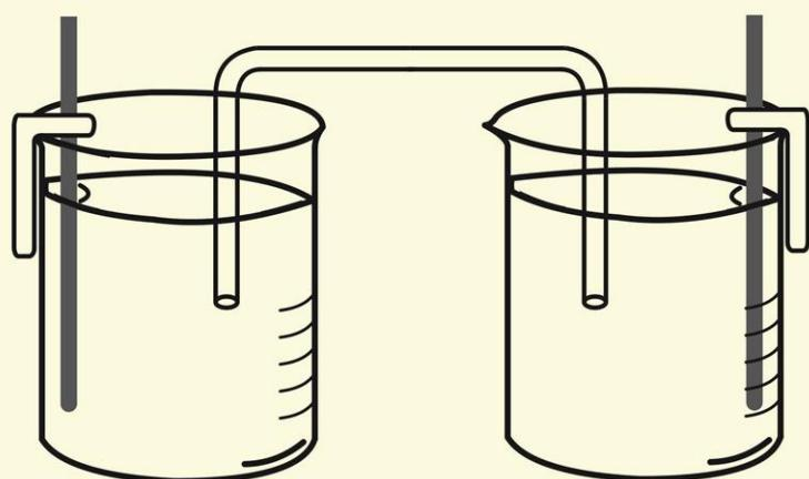
В каждый из стаканчиков помещают магнитную мешалку. К электродам подключают вольтметр с помощью соединительного провода «2 крокодила». Вольтметр подключают к учебно-лабораторному модулю. Подключают
