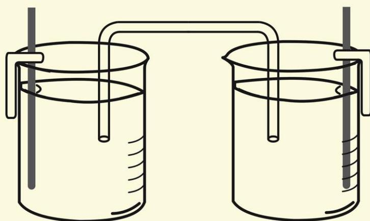
Она состоит из двух стаканчиков на 50 мл, соединенных солевым мостиком. В каждом из стаканчиков установлен электрод из нержавеющей стали. В стаканчике, в котором будет происходить титрование, должна быть мешалка, которая равномерно распределяет сгенерированные на катоде гидроксид-ионы по всему объему раствора.
