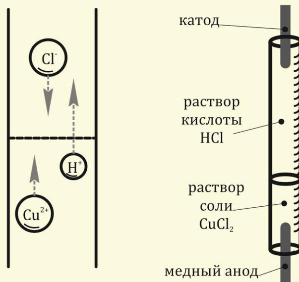
Схематическое изображение установки для определения чисел переноса методом подвижной границы
